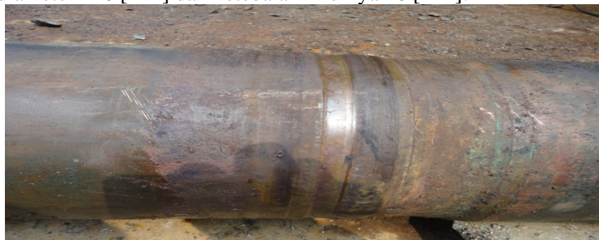
Gambar 3. Bagian Poros yang Bergesekan dengan Stern Gland Packing
