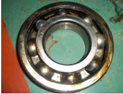
Gambar 1. Bearing yang mengalami keausan
