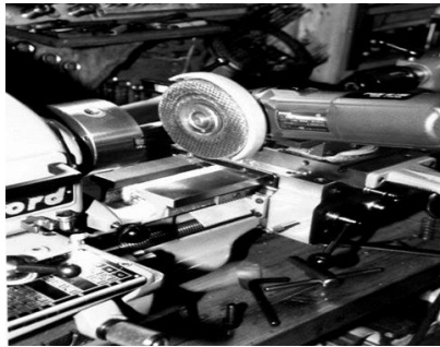
Gambar 1. Gerinda tangan dimodifikasi menjadi gerinda silindris [2]
