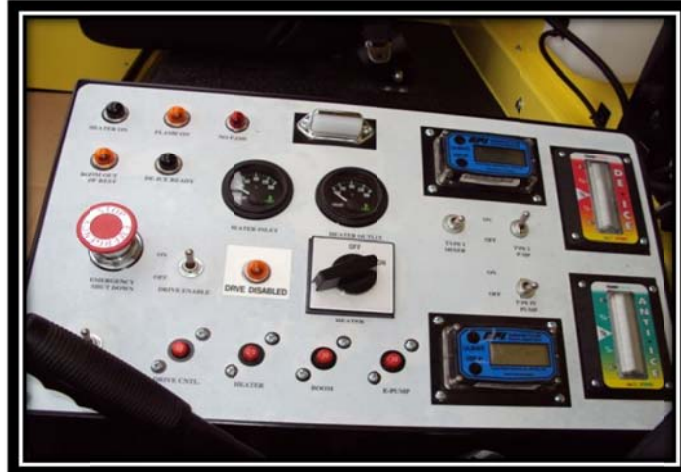
Gambar 2. Ilustrasi console box pada panel monitoring engine 3406
